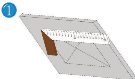
Misurate il telaio esterno e con l'ausilio di una falsa squadra disegnate il profilo dell'apertura sul soffitto in cui andrà collocata la botola.
