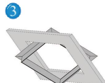
Prendete il telaio esterno della botola d'ispezione e facendolo ruotare inseritelo in diagonale attraverso l'apertura praticata, in modo tale che il telaio si trovi tra la lastra di gesso rivestito e l'isolamento.
